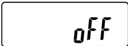
Чаще ИБП переходит в аварийный режим байпаса, при этом, обычно, связанных с неисправностями внутри ИБП или электросети, ИБП может самопроизвольно заблокироваться в выключенном состоянии. Дисплей при этом отображает информацию, как показано на рисунке Z, а также код ошибки:
