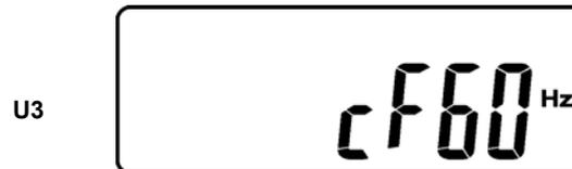
Режимы с фиксированной выходной частотой позволяют использовать ИБП, как преобразователи частоты для питания оборудования, требующего входной частоты, отличной от действующей в электросети.
